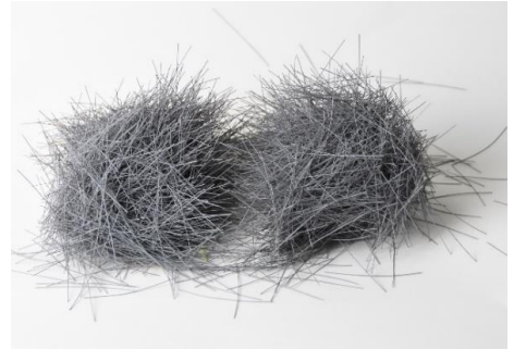
Figure 1 : Rupture d'un agrégat de fibres modèles enchevêtrées
